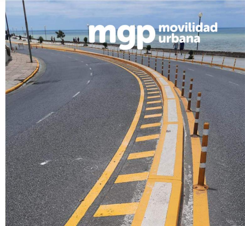
> **Mejorar la seguridad vial del sector**, incorporando infraestructura que genere condiciones de seguridad, garantizando la segregación entre los peatones y los vehículos motorizados. Se realizó una nueva demarcación horizontal, se colocaron señales vertical, un semáforo intermitente y elementos de seguridad.
